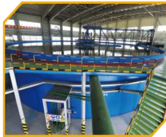
乌山铜钼矿使用膏体浓密机，以高效的方式回收尾矿中的水，达到了排出尾矿含水少、不扬尘、无污染的环保效果
