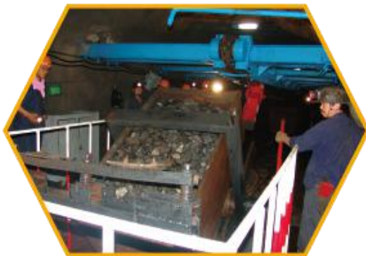
翟镇煤矿采用井下煤矸分离技术和原生矸石综采充填技术,实现矸石不升井和以矸换煤的目标
