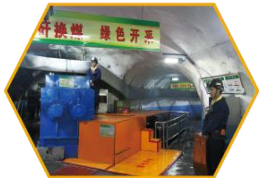
翟镇煤矿采用井下煤矸分离技术和原生矸石综采充填技术,实现矸石不升井和以矸换煤的目标
